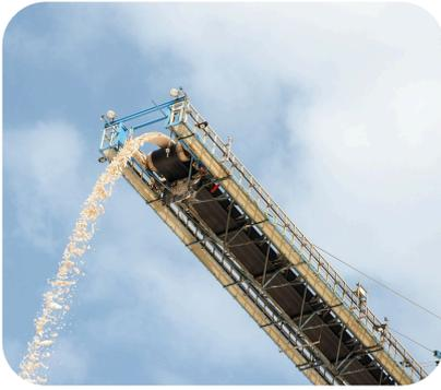
Las bandas de uso rudo son diseñadas para **resistir condiciones extremas y manejar materiales de alto impacto, abrasivos y de alta temperatura**. Son la opción ideal para industrias como la **minería, pavimentación de asfalto, reciclaje** y otras aplicaciones pesadas donde se requiere una resistencia excepcional a la abrasión, a las tensiones y a las temperaturas extremas.
